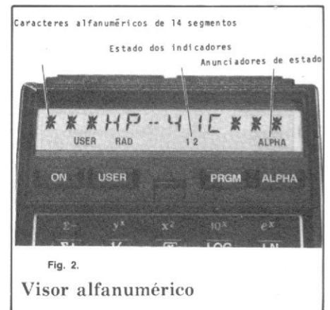
visor e o teclado se converte em um teclado alfanumérico de entrada, usando-se para isto o conjunto de caracteres impressos em azul na face das teclas. Várias funções, no conjunto de funções da máquina, permitem ao usuário manipular e visualizar o conteúdo do registrador alfanumérico através do teclado e/ou sob controle de um programa.
